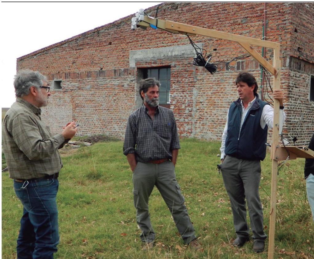
Figura 2. Soporte en forma de «L», con los cuatro sensores Decagon en un extremo, que permitieron medir la radiación en cuatro longitudes de onda en un área de aproximadamente 1,5 m<sup>2</sup>.
