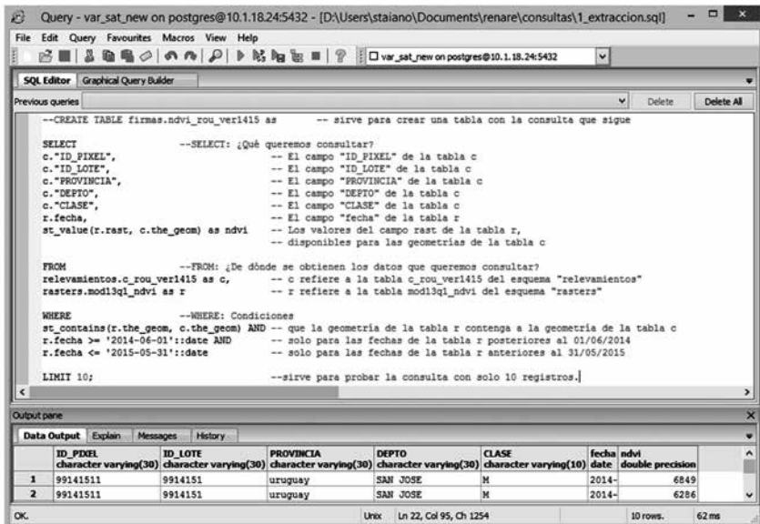
Figura Caja A.1.3.3. Visualización de una consulta SQL desde el cliente pgAdmin. Se muestra el código de la consulta comentado (panel superior) y las primeras filas del resultado (panel inferior).
